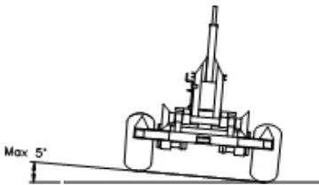
Placez la remorque polybenne sur une surface plane. L'inclinaison des côtés ne doit pas excéder 5 degrés.
