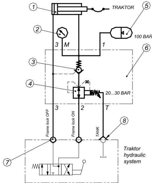
Figure 36. Système hydraulique du verrou de cadre.
