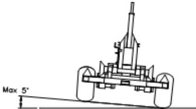
Placez la remorque polybenne sur une surface plane. L'inclinaison des côtés ne doit pas excéder 5 degrés.
