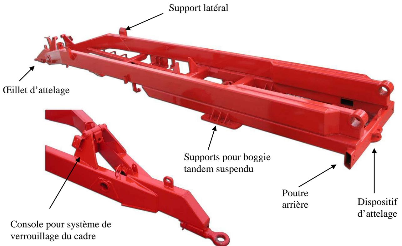
Figure 2. Châssis pour système de verrouillage du cadre
