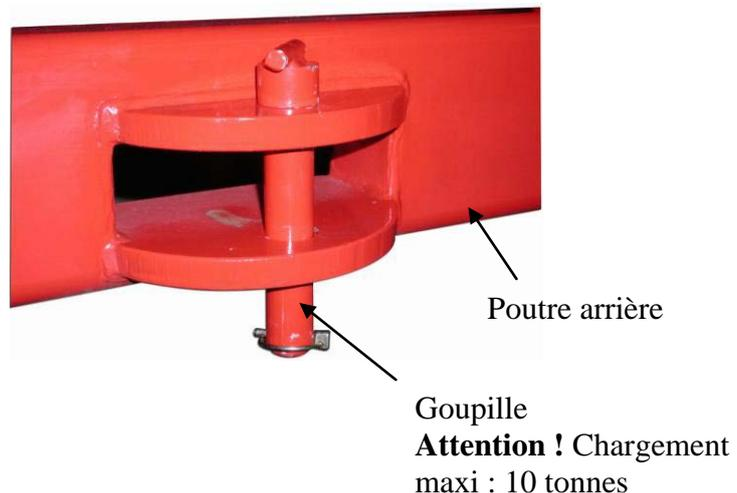
Figure 11. Dispositif d'attelage
