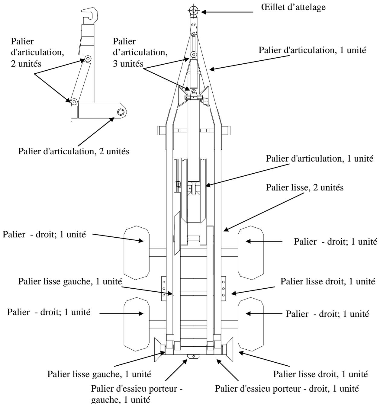
Figure 39. Schéma de graissage
