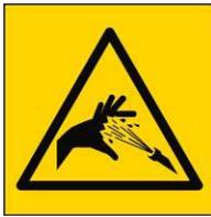
Figure 22. *Fluide hydraulique sous pression*
